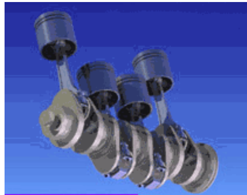
Figur.2 (Vevaxel med stakar och kolv)
